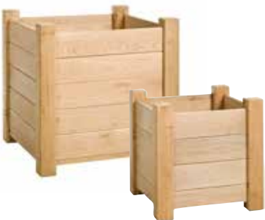
Eiken bloembak De bloembak is vervaardigd uit eiken palen 9x9 cm en eiken veer-en-groef planken van 1,8x14,5 cm. Inclusief PVC bescherm laag aan de binnenzijde. (hxbxd) 58x58x58 cm 08970 162,50 (hxbxd) 87x87x87 cm 08971 289,-
